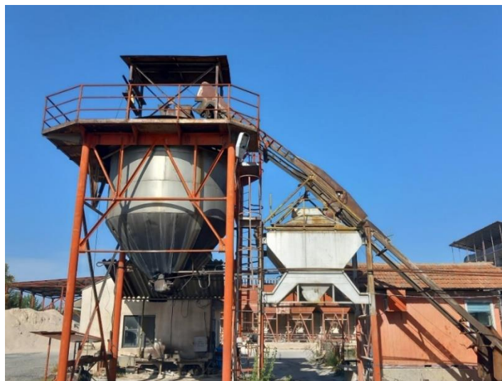
Слика 17. Силос за складирање со дозатор за полнење камиони за транспорт на готов асфалт
