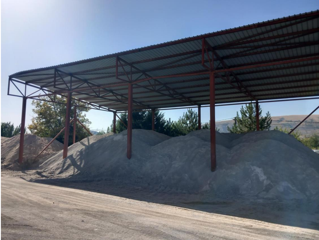
Слика II.11. Покриено складиште за ризла-камен агрегат, поделен на повеќе бункери за складирање камени фракции. Камените фракции се со димензии од 0-4; 4-8; 8-11,2; 8-16; и 16-22,4 mm.
