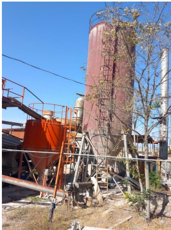
Слика 13. Силоси за складирање филер со капацитет од 60 t (десно) и повратен слилос за филер од 10 t (лево).
